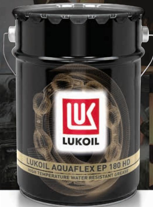
Антифрикционная высокотемпературная смазка, применяемая в высоконагруженных узлах трения скольжения оборудования, работающего во влажной среде, в условиях ударных и циклических нагрузок. Применяется для смазывания узлов промышленного оборудования, строительной, буровой, горнодобывающей, судовой техники и транспортных средств. Смазка содержит твердый наполнитель.
